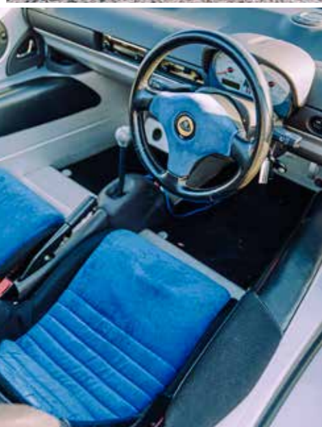
Erstaunlich angenehme Sitze aus Glasfaserverbund direkt überm nackten Alu-Chassis
