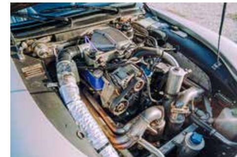
Nochmal Rover, aber V8. Die Abgasführung nach vorn ist abenteuerlich, genau wie die Leistungsentfaltung
