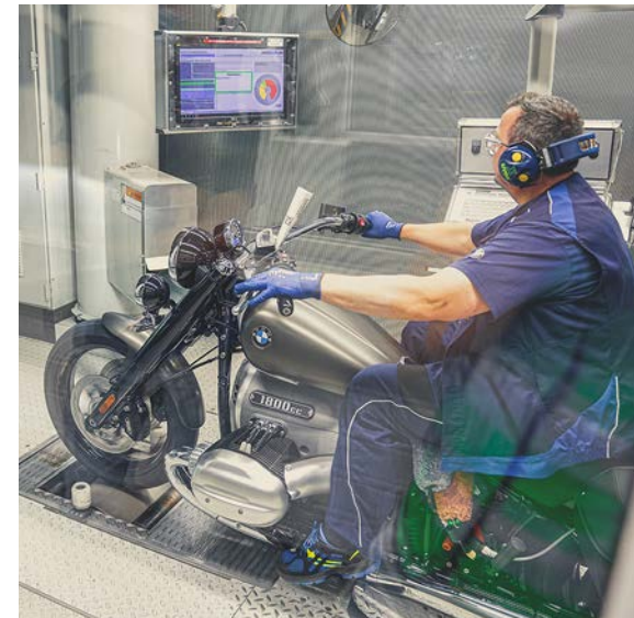
Der Motor erwacht zum Leben Die Prüfstandsfahrt auf der „Rolle“ beendet die Montage. Aus Tausenden Teilen ist ein mechanischer Organismus geworden
