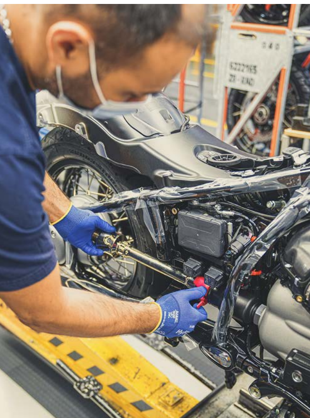
Trotz Hightech ist der Anteil echter Handarbeit groß. Gerade wird die offene Antriebswelle der R18 montiert
