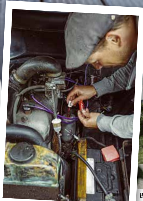
Roter Nagellack fixiert als Schraubensicherung das Gehäuse des Ölfilters
