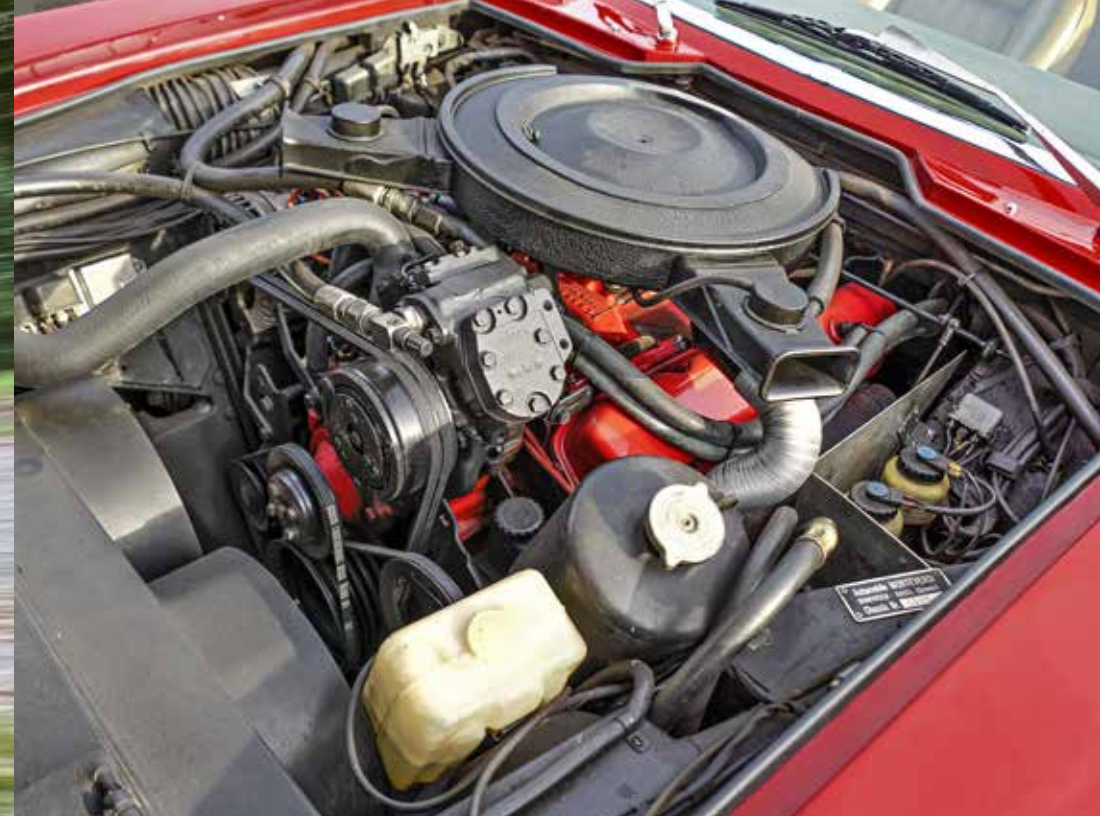
Der V8 im 375 L drängt sich eng an die Spritzwand. So wird der schwere Brocken zum Dynamiker
